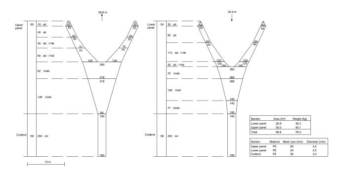
**Figure 2.** Crustacean trawl design utilized during experimental fishing. **Figura 2.** Plano de la red de arrastre de crustáceos utilizada durante la pesca experimental.
